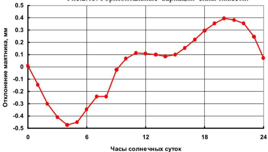
В трудах А.Я.Орлова, известного геодезиста и гравиметриста, который в 1909(!) году исследовал горизонтальные вариации силы тяжести, экспериментируя с маятниками Цельнера, на Рис.2.15 демонстрируется реакцию маятника на солнечные воздействия.
