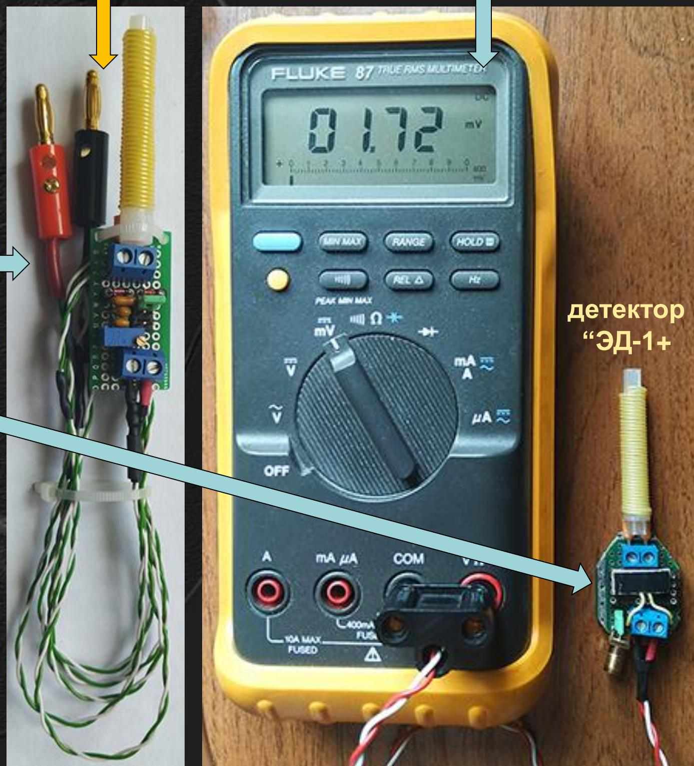
Цилиндрический бифиляр 20 вит. на  $\Phi = 8-10\text{mm}$
