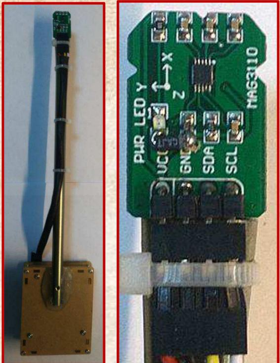
Магнитные измерения на поверхности проводника с током.
