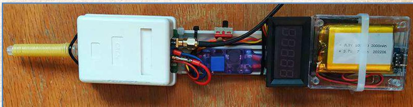
Измеритель ИГЭД-2гр с гальванической развязкой ( $R_{inp}$  входное = **50 Mом**) справа и параллельным выводом на цифровой осциллограф фирмы **FNIRSI-138 Pro** (слева) – оба на аккумуляторном автономном питании.
