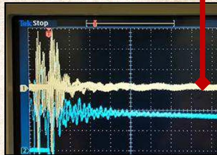
На фото справа - продолжение правой части импульса говорит о быстром затухании сигнала (не более  $5.5\mu\text{S}$ ), соответствует показаниям на осциллографе **FNIRSI**, после всплеска - колебания чисто **эфирной среды**, смотри на предыдущем слайде. ^
