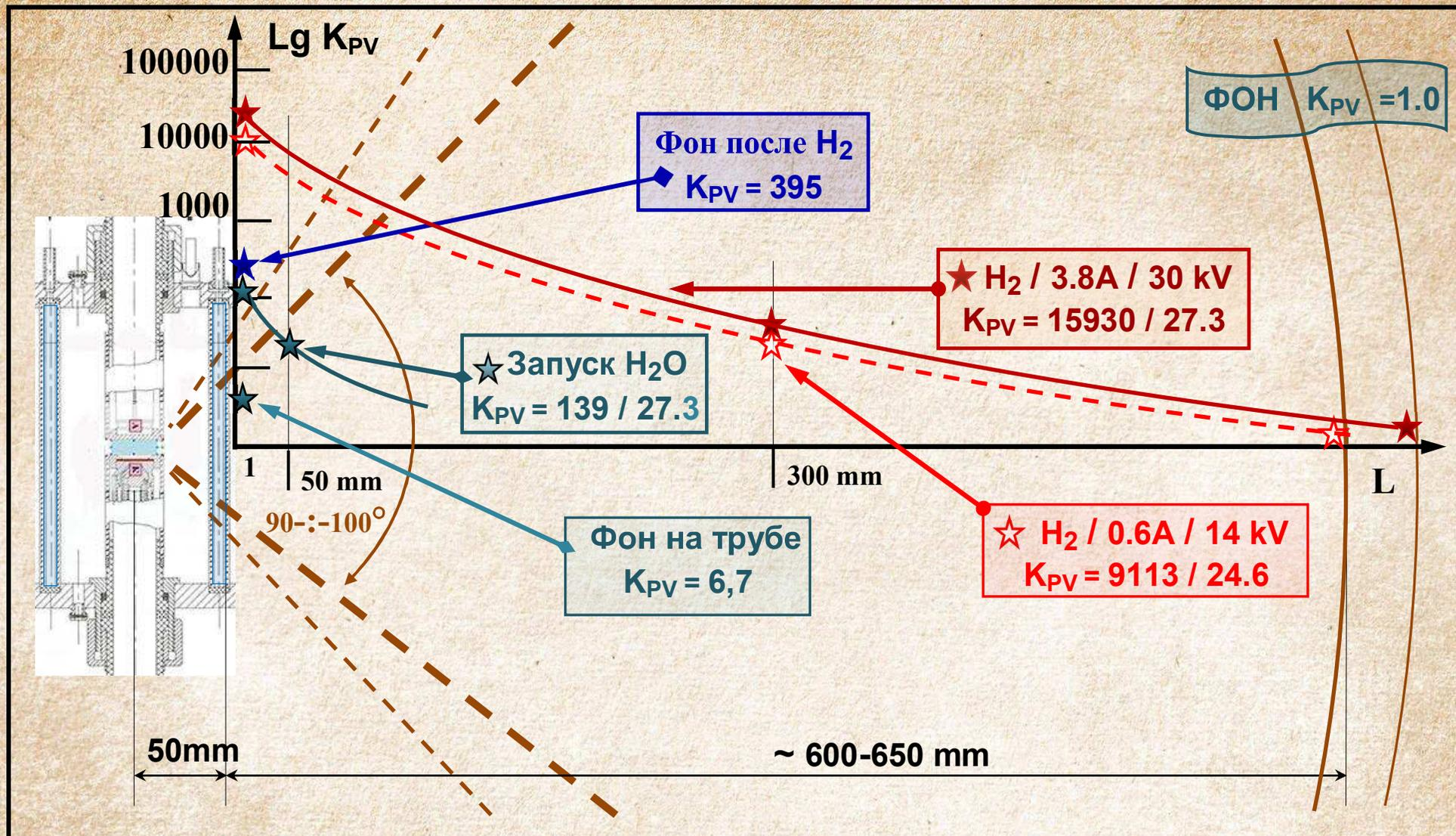
Измерения на установке показали, что распространение излучения происходит симметрично в растворе цилиндрического конуса с углом раскрытия приблизительно в  $90^\circ$ - $110^\circ$ , из области, где происходит разряд.
