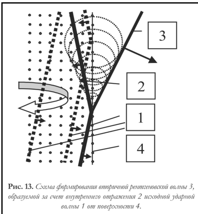
Рис. 13. Схема формирования вторичной рентгеновской волны 3, образуемой за счет внутреннего отражения 2 исходной ударной волны 1 от поверхности 4.
