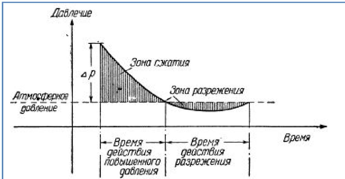
Рис 5. Распространение давления ударной волны в газе.
