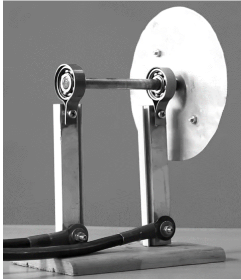
Рис. 31. Фото электродвигателя на подшипниках [328].
