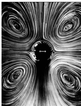
Рис. 11.10. Вторичные вихри, индицируемые колеблющимся цилиндром Течения вокруг цилиндра подобны течениям вокруг Солнца как центробежного насоса.
